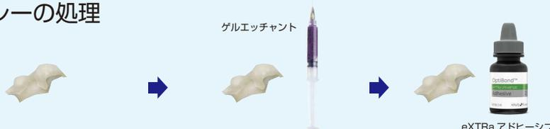
**50μm**の酸化アルミナ**2気圧**、ジルコニアは**4気圧**でサンドブラスト処理後、水洗します。
