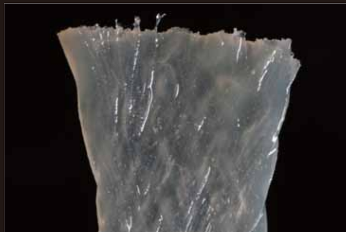
2 コンストラクトリボン2mmにコンストラクトレジンライトを浸透させた拡大写真。
