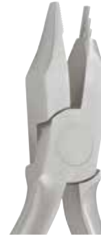
678-306 ¥21,000 Tweed Loop Forming Pliers ツイードループ フォーミングプライヤー ツイード 3段階(.055”、.075”、.090”)の 作業部で正確にフォーミング 【屈曲許容径】~.022” x .025”
