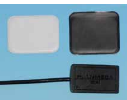
図1. 厚さとケーブルの存在がCCDセンサー(下)の扱いを困難にしている。上は従来型フィルム(左)とイメージングプレート(右)。
