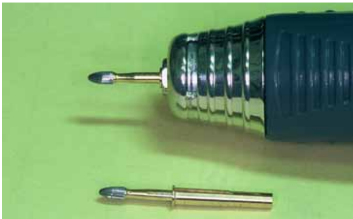
2. 技工用エアターピンが無い場合、FGアダプター(デンタルエイド株式会社)を使用すれば、技工用マイクロモーターにFGバーの装着が可能である。
