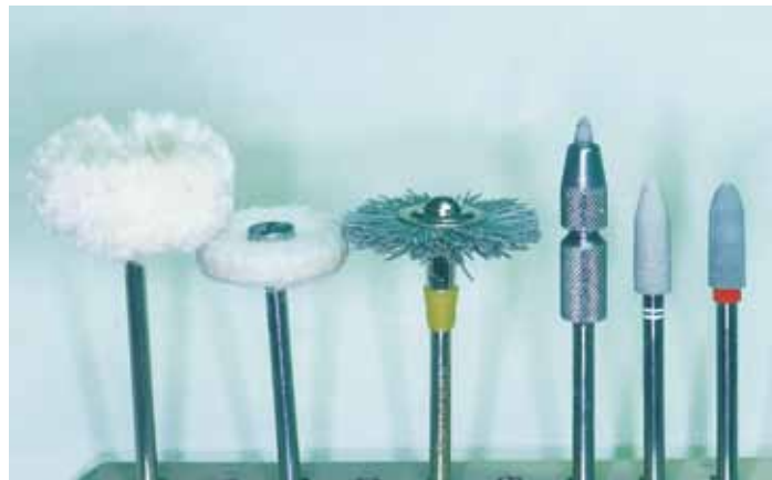
3. 筆者がハイブリッドレジンの研磨に用いるポイント類。 左から、ウールホイール(内外歯材株式会社)、エステニアフェルトホイール(株式会社モリタ)、マルチフィックスV(サイブロン・デンタル株式会社)、ダイヤモンド含有シリコンポイント(株式会社茂久田商会)、ダイヤモンドポリッシャー:セラマスターHP13S(株式会社松風)、シリコンポイント:HR2HP13S(株式会社松風)
