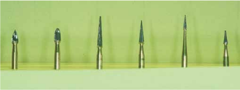
1. 筆者が使用するブルーホワイトカーバイドバー6種の番手と形状。 左から、7104(フレーム)、7406(エッグ)、9714、7714、7610(以上、テーパーフィニッシング)、7103(コンケーブインタープロキシマル)
