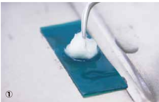
① 光沢面を水で濡らし、接着力を発現させる。
