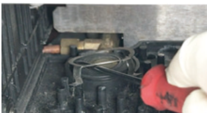
① マイナスドライバーで排気シール押さえを取り外します。
