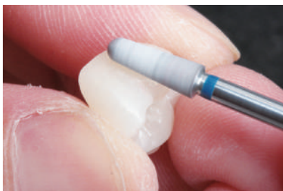
ジルコニアの研削、概形面の形態修正。研削による黒い跡は見られない。
