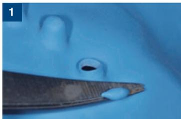
1 ホールの位置や大きさは突出部をカットするだけで適正に設置できる
